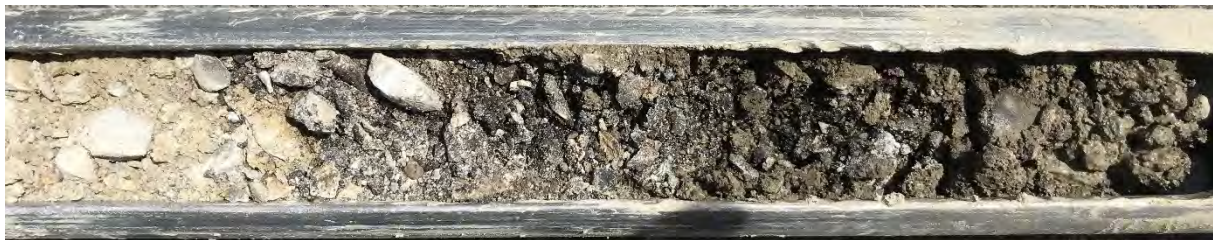
Bild 5: Unsortiertes Schotter-Fräsgut-Gemisch als Auffüllung (RKS 7)
