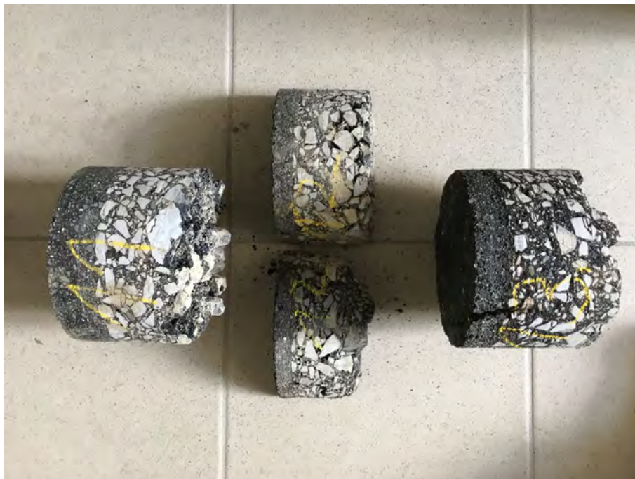
Bild 3: Asphaltbohrkerne KB 11 - KB 13 (Gehweg Hauptstraße)
