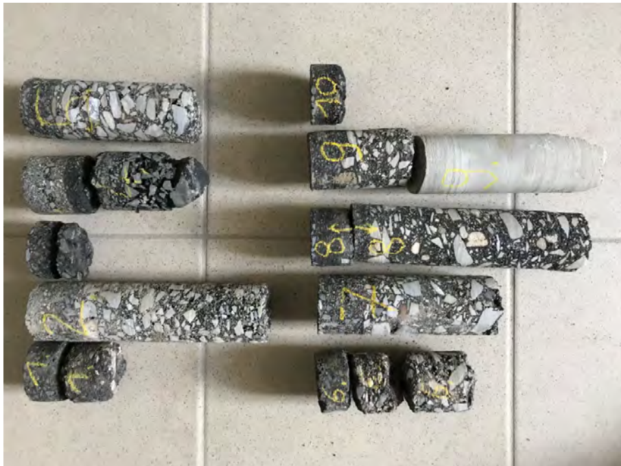
Bild 2: Asphaltbohrkerne KB 1 - KB 10 (Hauptstraße, Webergasse, Wipfelder Straße)
